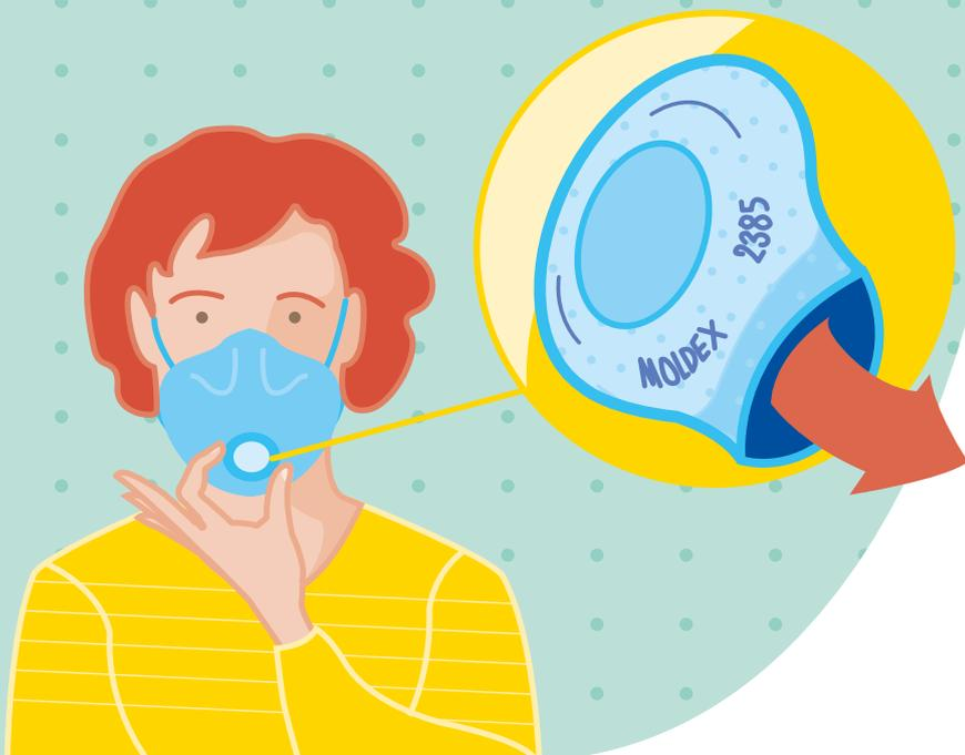
Das Ventil an einer FFP-Maske ist ein zusätzliches Komfort-Merkmal. Es öffnet sich beim Ausatmen, beim Einatmen bleibt es dicht verschlossen.
