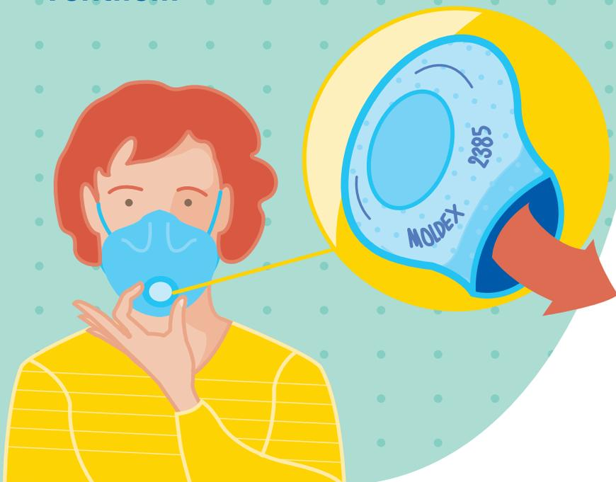
Ventil FFP respirátoru je dalším prvkem zajišťujícím komfort. Otevírá se při výdechu, při nádechu zůstává těsně uzavřený.
