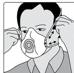
4. Para asegurarse un buen ajuste tirar de la correa hacia un lado u otro.
