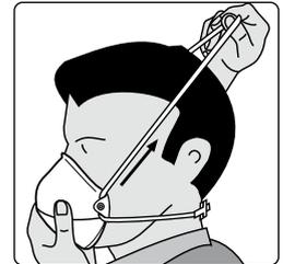
4. Das obere Band straff und weit nach oben ziehen, dann auf den Hinterkopf aufsetzen.
