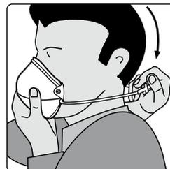
3. Die Maske am Kinn ansetzen und das untere Band über den Kopf bis zum Nacken nach hinten ziehen.
